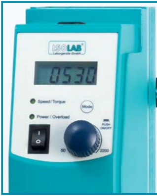
Geniş LCD panelde eş zamanlı olarak ayarlanan ve ulaşılan hız gözlenebilir.
