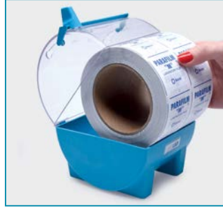
Parafilm kutuya yerleştirin ve kesme mekanizmasını eski yerine çekin.
