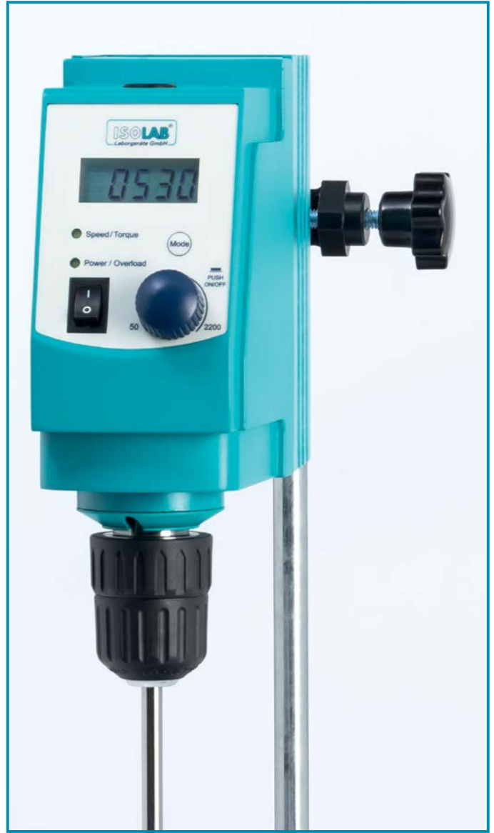
Geniş LCD panelde eş zamanlı olarak ayarlanan ve ulaşılan hız gözlenebilir.
