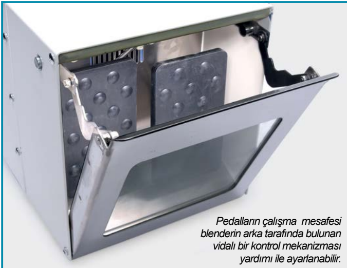
Pedallar üzerinde bulunan yumuşak koruyucular homojenizasyon etkisini artırır ve kapaktaki camın kırılmasını önler.
