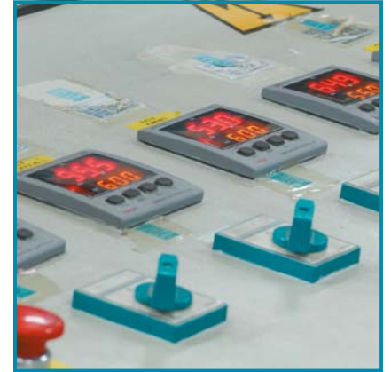
Fırın her aşamada hassas sıcaklık ayar ve kontrolünü garantileyen elektronik kontrol paneli ile donatılmıştır.
