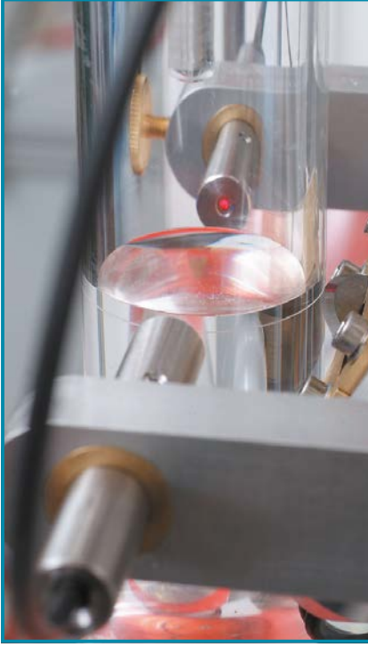
Menisküs çizgisi lazer ışık düzeyinin en alt çizgisinden oluşturulmaktadır.
