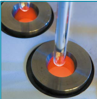
Borular önce camın yarı erime derecesine kadar kademeli olarak ısıtılırlar. Daha sonra hassas çaplı çelik borular üzerinde biçimlendirilirler.
