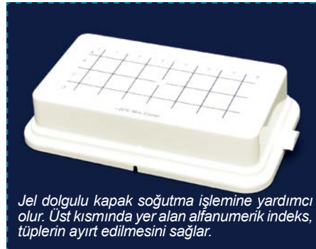
Şeffaf kapak kutu içindeki tüplerin kolay gözlenmelerini ve toz, rutubet ve diğer dış çevre şartlarından korunmalarını garanti eder.
