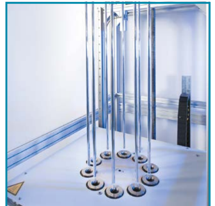
Büret boruların uzunlukları boyunca daima aynı çapa sahip olabilmeleri için vakum daraltma teknolojisi ile biçimlendirilirler.
